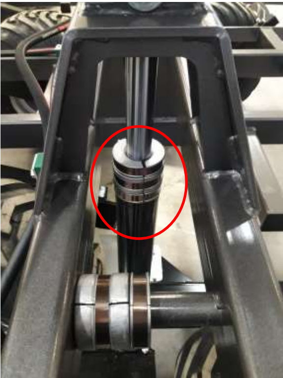
Kuva 11. Työsyvyyden säätäminen keski ja sivulohkossa
