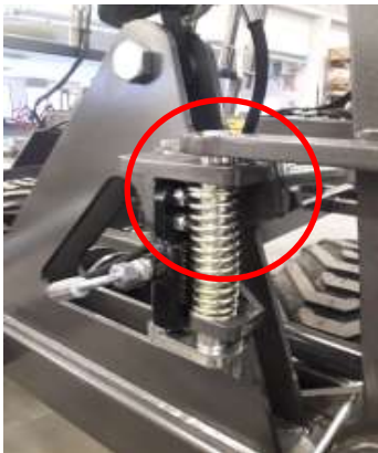
Kuva 3. Sivulohkojen mekaaninen lukitus kiinni asennossa.
