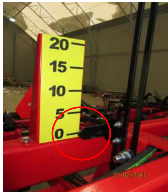
Kuva 10. Työsyvyysmittari sijaitsee äkeen keskilohkon päällä.
