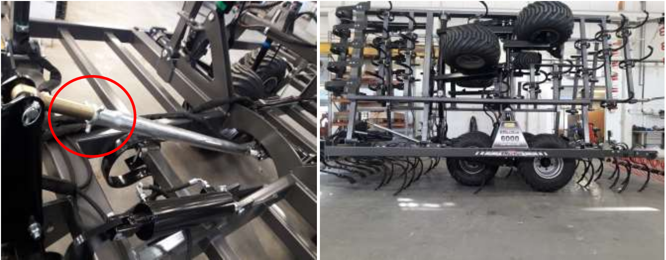
Kuva 5. Koneen säätö vaaka-asentoon. Punaisella ympyröity työntövarsi ja vieressä äes vaakatasossa
