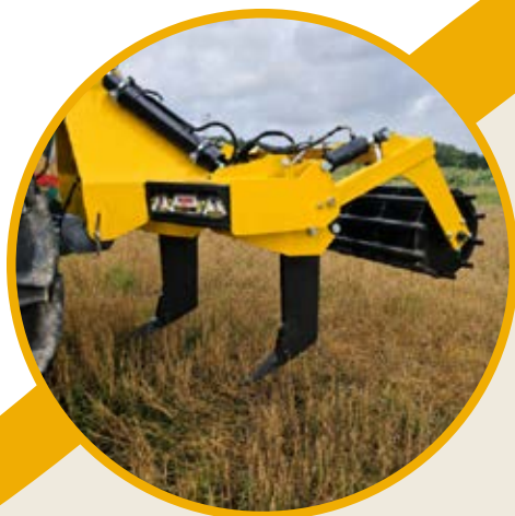
Hydraulinen automaattilaukaisu piikeille, säädettävällä paineella maalajikohtaisesti
